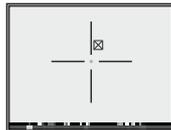
Manteniendo la retícula en el punto de puntería, desplace la cruz auxiliar al punto de impacto girando el regulador a lo largo de coordenadas X y Y. Para cambiar a la coordenada Y, presione brevemente el regulador o el botón (15) del control remoto. Para desplazar la cruz auxiliar a lo largo de coordenadas X y Y, gire el regulador o presione botones del control remoto: el botón (16) para aumentar el valor; el botón (14) para disminuir.
